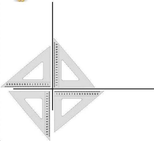
On place l'angle droit de l'équerre dans l'angle que l'on veut vérifier. Si les deux droites sont perpendiculaires, les deux bords de l'équerre coïncident exactement avec les deux droites. On peut placer l'équerre de différentes manières.
